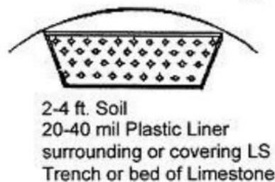
**Abbildung 26: Schematische Darstellung eines ALD [17]**
