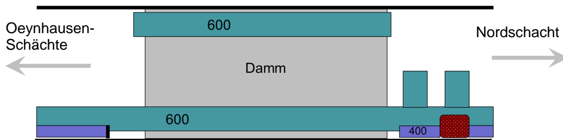
Abbildung 19: Seitenansicht des Damms 3. Sohle / Nordquerschlag.
